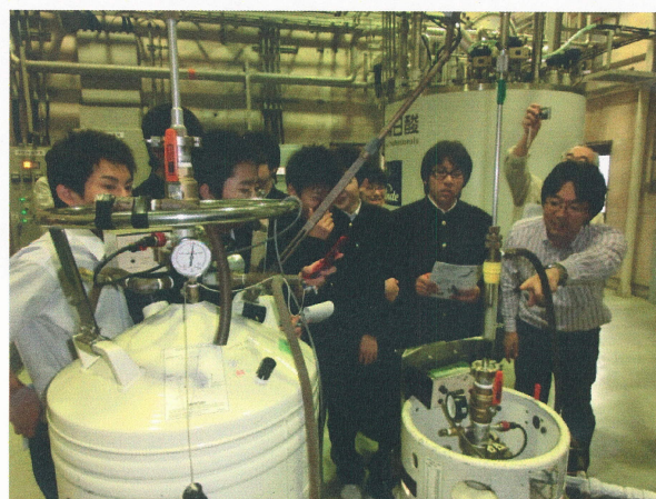
図2 宮城県工業高校の見学における、ガラス製2重管を用いた液体ヘリウムのトランスファーの実演の様子。
