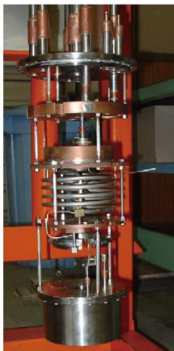
図 2 多元技術室で作成した希釈冷凍機。STM ヘッドを組み合わせて試料搬送に対応した構造。
