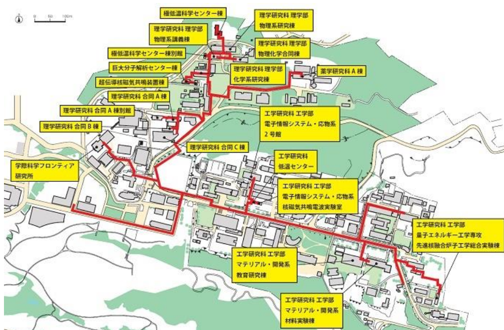
図5 青葉山キャンパスヘリウムガス回収網
