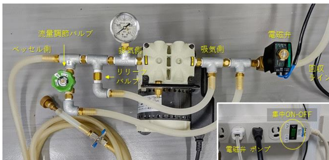
図1 トランスファー用加圧装置の写真。流量調節バルブ(ニードルバルブ)を絞ると加圧され、開けると減圧される。これは電磁弁がついているバージョンであるが、電磁弁は必ずしも必要ではない。
