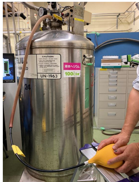
図4 （株）ニシヤマ製ガスバッグを使った加圧。
