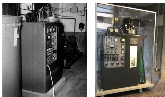
図2 日本初の Collins 式ヘリウム液化機 左：設置当時の写真(東北大学資料館写真データベースより)、右：現在金属材料研究所展示
