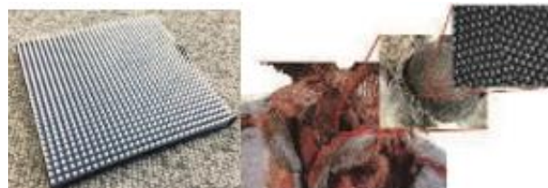
図 6. 左: Moth-eye 構造を参考にして 3D プリンターで成形したミリ波吸収源[9,10]。右: 蛾の目の顕微鏡画像。光を反射して目がキラッと目撃動物に発見されないよう広帯域の光に対して反射率を抑制する理想的反射防止構造になっている[8]。
