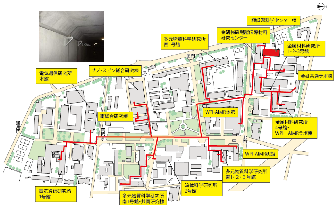
図8 東北片平キャンパスヘリウムガス回収網（赤線）と共同溝内の配管の写真（左上）
