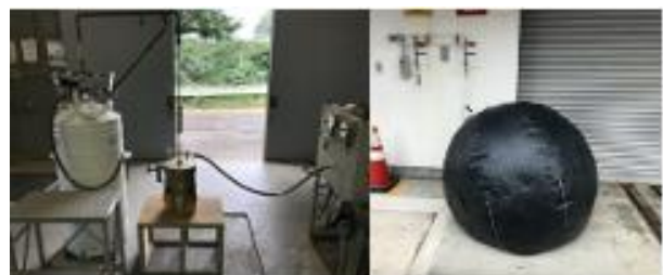
図 4.左：クライオスタットへのヘリウム注入の様子。右：ガスバックによるヘリウムガス回収の様子。
