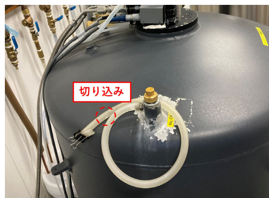
図 6. 窒素ジャケットの閉塞防止用のゴムチューブ。
