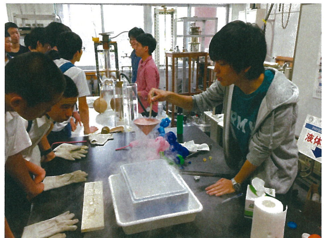
図2 オープンキャンパスで、液体窒素を使って空気中の酸素を液化している様子。
