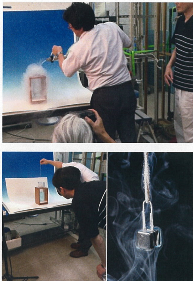
図4 パンフレット撮影会で液体酸素を透明デュワーに汲み込んでいる様子（上）とネオジウム磁石を液体酸素に浸したている様子。
