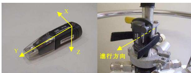
図2. CEMインスツルメンツ製3軸振動データロガーDT-178A（左）、治具（ロガー付属品）とマジックテープバンドで容器のヘッド部分に固定した様子（右）
