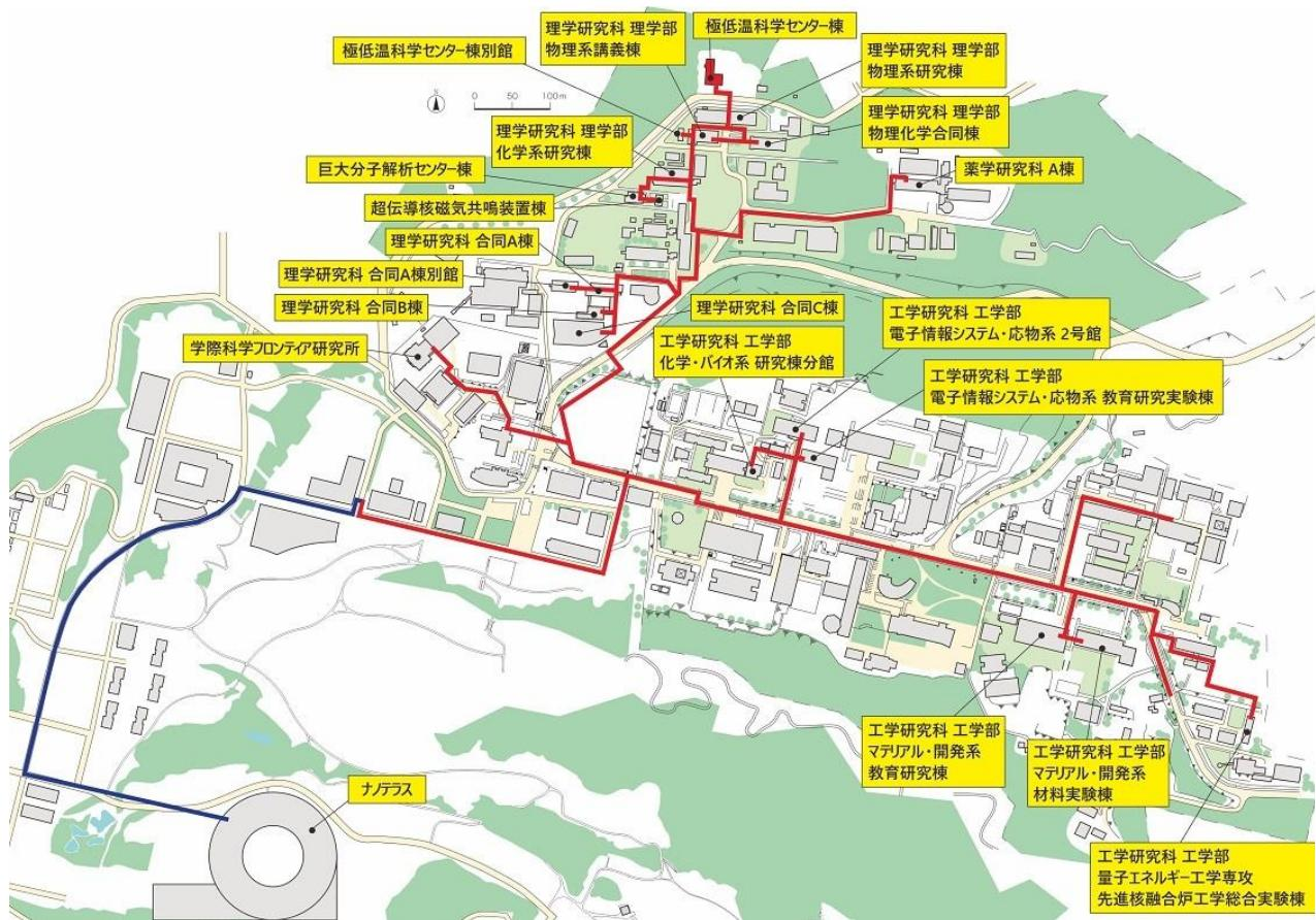
青葉山地区ヘリウムガス回収配管図（赤線）
