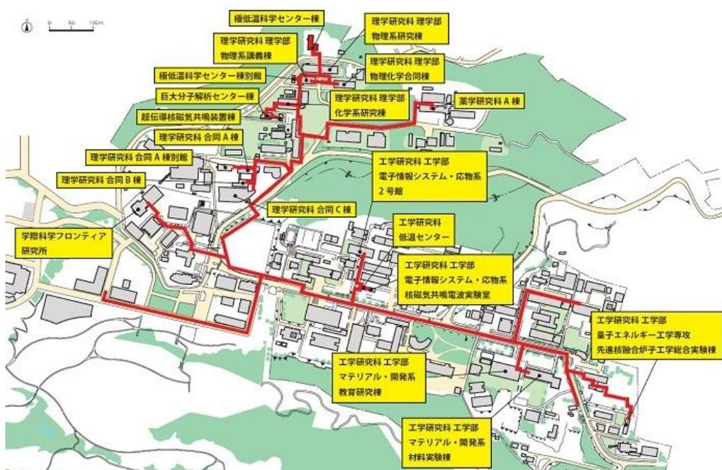
図5 青葉山キャンパスヘリウムガス回収網
