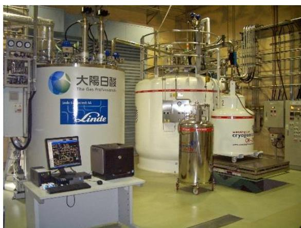
LINDE 社製 200L/h 型ヘリウム液化機
