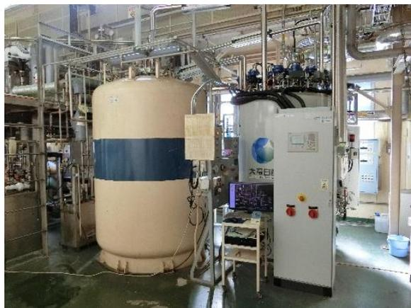
LINDE 社製 50L/h 型ヘリウム液化機
