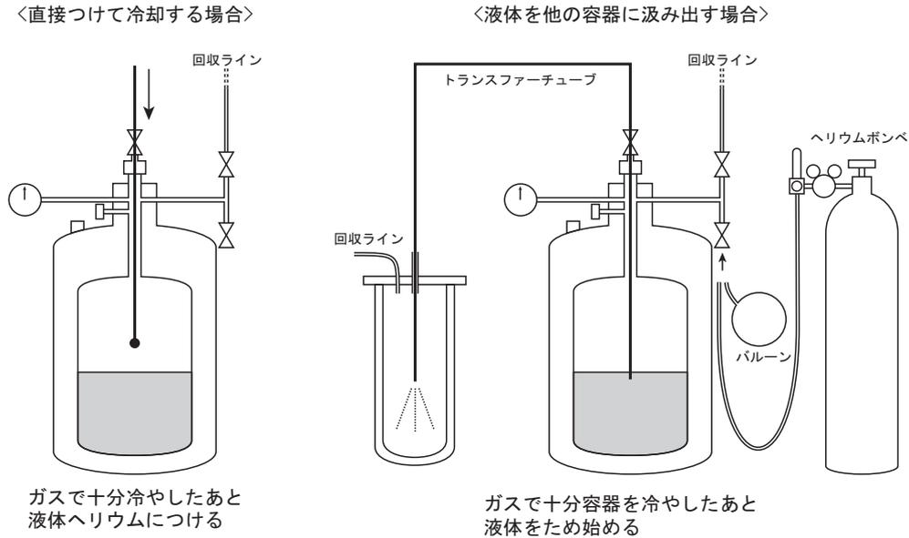
図 5: 液体ヘリウムによる冷却
